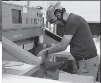
Ein sehr eindringliches Beispiel, welche technischen Möglichkeiten in der modernen Maschinentechnik realisiert werden können, konnte in der Werkstatt in Kehl Kork demonstriert werden: die Papierschnidemaschine, welche mit höchster Präzision Papier schneidet und mit einer modernen Sensortechnik so ausgestattet ist, dass selbst beim Hineingreifen in die Maschine nichts passieren kann. Ein tolles Beispiel wie Arbeitsprozesse auch für Menschen mit Epilepsie sicher gestaltet werden können.
